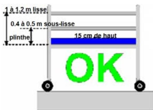
Figure 43: Garde-corps échafaudage roulant
