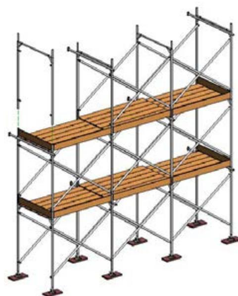
Figure 4: Échafaudage modulaire à cadres en "H"
